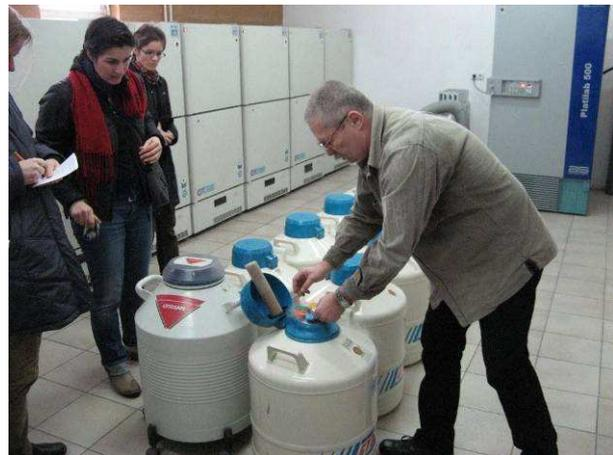
**Abb. 3: In diesen Behältern wird das Roggensaatgut in flüssigem Stickstoff aufbewahrt.**
