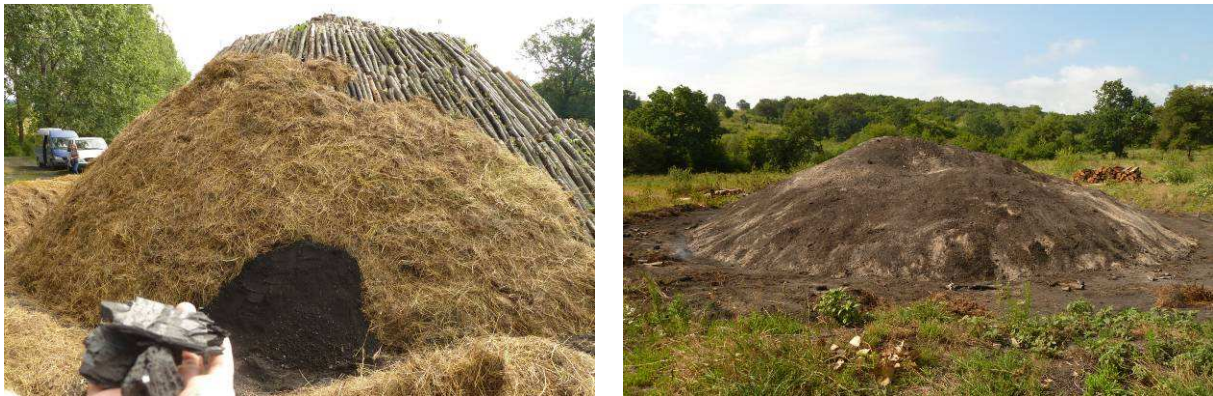
Abb. 8: links ist der Aufbau des Kohlemeilers sichtbar (Holz-Stroh-Asche/Erde Gemisch); rechts ein abgebrannter Kohlemeiler
