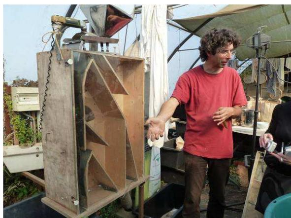
Abb. 2: Peter erklärt die Funktionsweise des selbst gebauten Gerätes für die Saatgutreinigung
